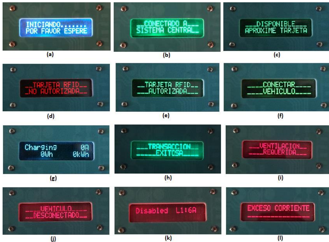
Ilustración 20 – Display de los estados y errores en el OpenEVSE
