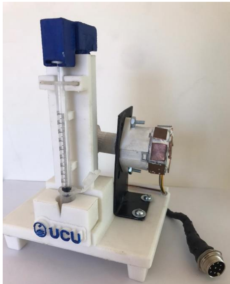
Figura 21. Sistema mecánico con el motor de paso y el sensor de efecto hall unidos.
