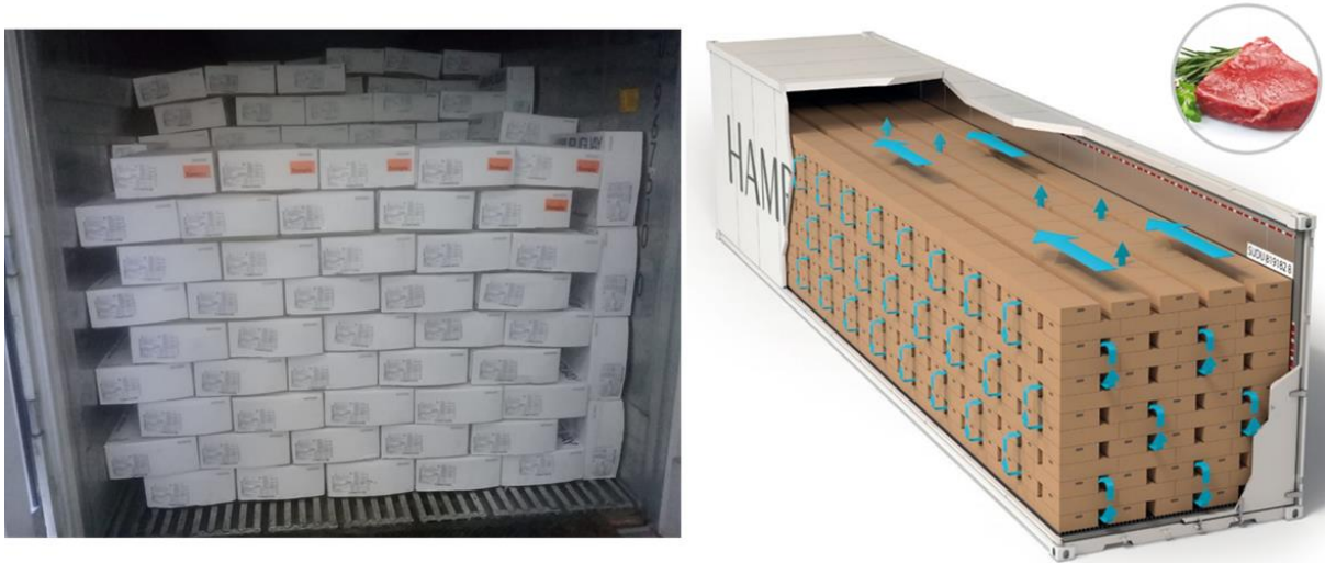
Imagen 6: Comparación entre el método actual de estiba del Frigorífico Sirsil y el método de estiba recomendado por Hamburg Süd
