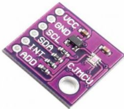
Imagen 20: Sensor OPT3001 y gráfico de respuesta en frecuencia [18]
