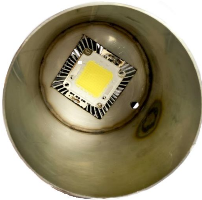
Imagen 69: Estructura del led 100W con disipador frontal
