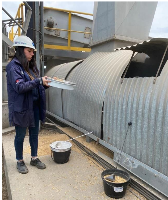
Ilustración 17: Surveyor tomando muestras del grano de soja de la cinta transportadora
