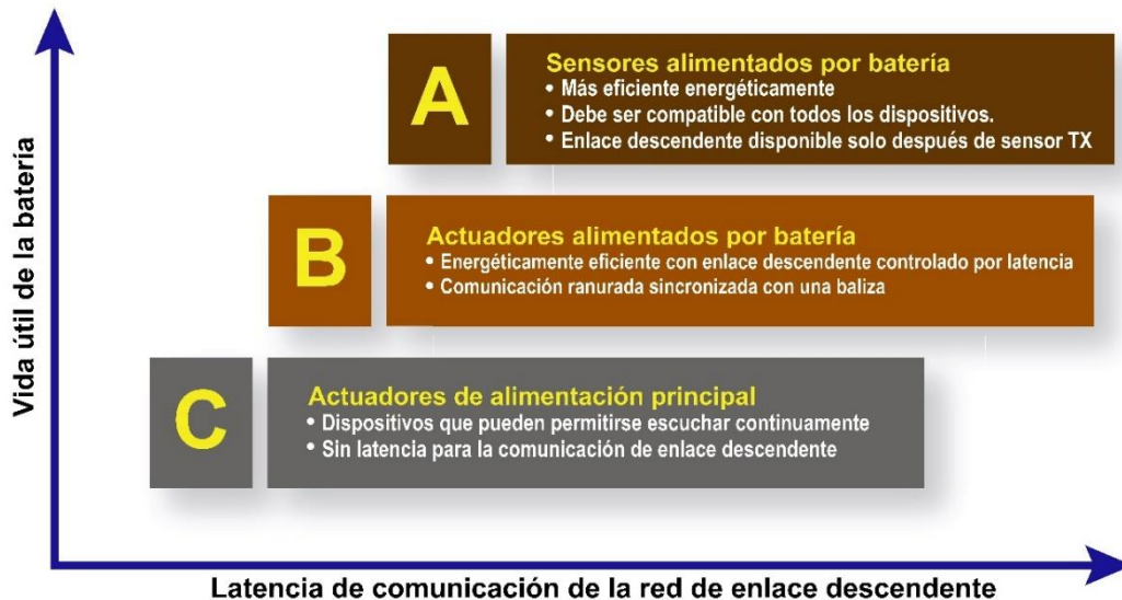
Figura A2.7 - Clases de LoRaWAN. [6, p.10]
