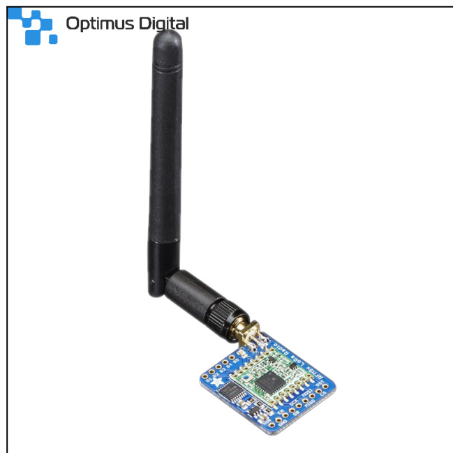
Figura 24: Kit de testeo de transductor RFM95W de 915Mhz, transductor opción 4 visto en la sección 6.2.1 (opción preferente) [40].
