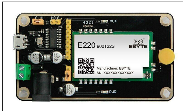
Figura 23: Kit de testeo de transductor EBYTE de 915Mhz, transductor opción 2 visto en la sección 6.2.1 [39].
