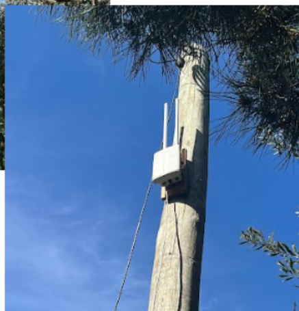
Figura 36: Emplazamiento del Gateway a 5m de altura. Imágen tomada al momento de realizar la experiencia.
