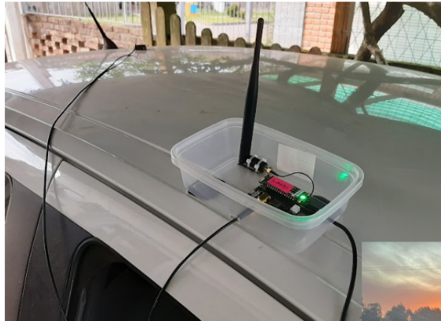
Figura 35: Monitoreo de señal en Servidor TTN de Nodo utilizado en la experiencia. Imágen tomada al momento de realizar la experiencia.
