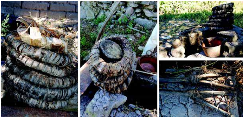
Figura 9. Instrumentos rústicos de trabajo que elabora y utiliza don Donato Chávez Carrillo, huichol, para producir el tuchi o mezcal en la comunidad de Guadalupe Ocotán, Nayarit. En las fotos observamos el destilador hecho con aros o rodets de corteza de árbol y zacate, cubierto y sellado con barro. Foto: Carlos Lazcano Arce, 2002
